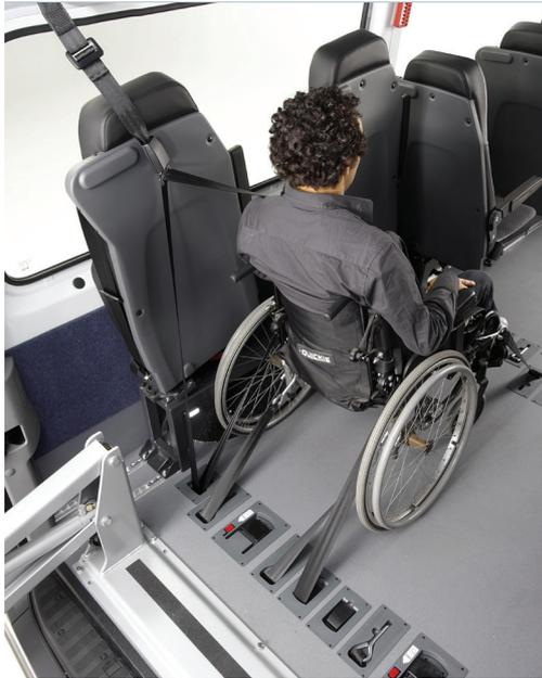
Die Rollstuhlbefestigung ist in Minibussen mit Smartfloor PLUS sehr einfach.
