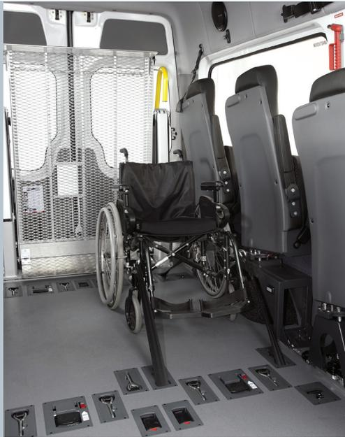
Das System ist vollständig im Smartfloor PLUS Boden versenkt.
